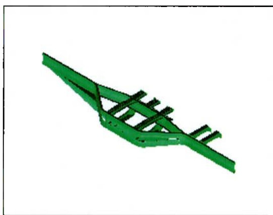
FIGURA 14 – Modelo CAD obtido (no formato IGES) do novo conceito de chassi escada
