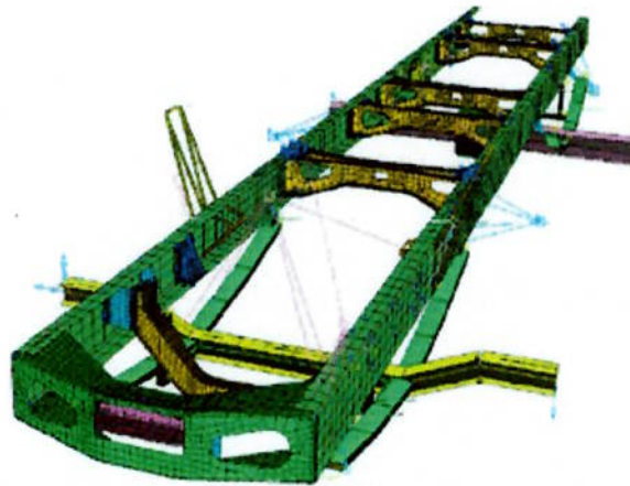
Figura 5 - Modelo de chassi de caminhão para simulação em computador utilizando o Método dos Elementos Finitos.
